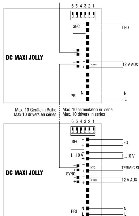
**Schema con pulsante - Diagram with push button - Diagramm mit Taster - Schéma avec bouton**
