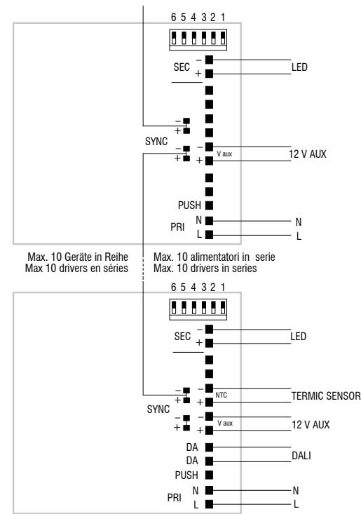
**ATTENZIONE:** la connessione PR può aumentare il potenziale di tensione del dissipatore LED (o di parti metalliche della lampada qualora il dissipatore fosse ad essa collegato) riferito al potenziale di terra. Valutare l'impiego di questa connessione in base agli Standard di Sicurezza relativi all'applicazione (per dettagli consultare il datasheet).
